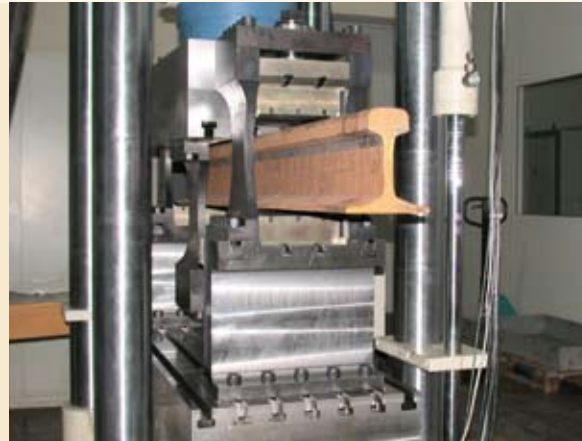
NOVUM: Untersuchung der Leistungsfähigkeit von Schienen
