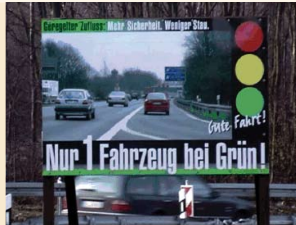
Zufahrtsregelung des Typs IRAMES auf der A40 Bochum-Zentrum, SSP 2004, einer der 100 derart regulierten Standorte in Deutschland
