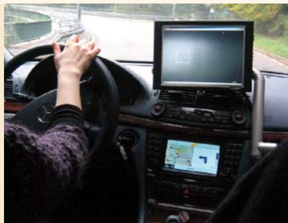
Prototyp einer PSA SafeMap, die den Fahrer 8 Sekunden vor Erreichen der Gefahrenzone visuell vor einer gefährlichen Kurve warnt.
