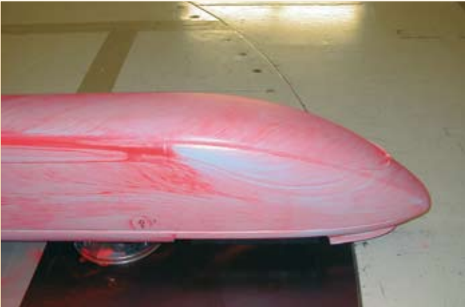
CROSSWIND: Modell zur Untersuchung der Windempfindlichkeit
